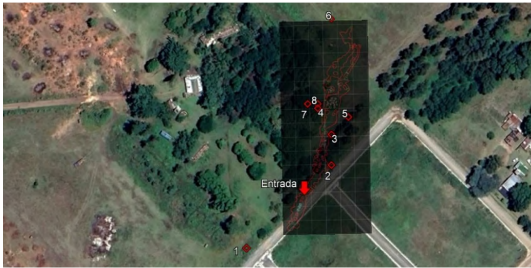
Figura 9 - Piques tapados o depresiones identificadas en superficie que aún no están conectadas con el mapa topográfico.
